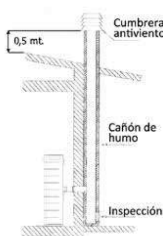
Fig. 2: conexión con el cañón de humo
